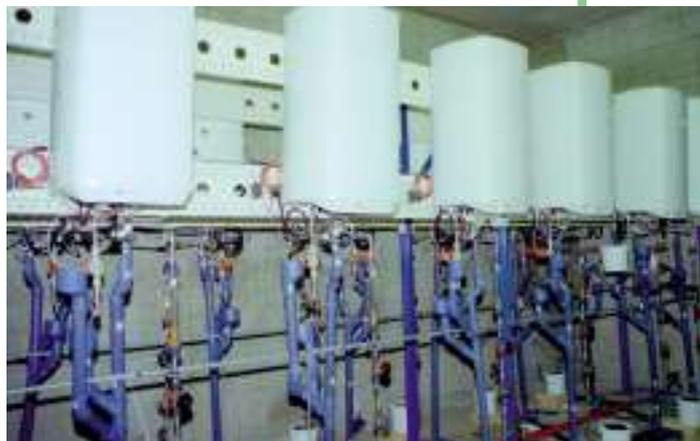
Der Prüfstand: In einer ganzen Batterie derartiger Warmwasserspeicher prüften wir, ob die Wasserbehandler Kalkablagerungen vermindern können oder ob nicht – immer unter gleichen Versuchsbedingungen.
