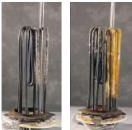
Kalkkiller mit und ohne Wirkung: Links die Heizstäbe aus einem Testboiler mit vorgeschalteter funktionierender Wasserbehandlung, rechts das Ergebnis bei mangelhafter Wirkungsweise. Bei dieser Testreihe verwendeten wir Heizstäbe mit unterschiedlich viel Power: Kalk fand sich überall. Am meisten aber lagerte sich auf den Metallflächen mit der stärksten Heizleistung ab – die dicken Ablagerungen sind gut erkennbar.
