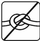
Achten Sie darauf, dass die beiden Schläuche für Wasserzu- und ablauf nie gequetscht, geknickt, verdreht oder verstopft sind. Und bitte daran denken: Der Schlauch für den Ablauf des sauren Wassers ist stets so zu legen, dass das Wasser herausfließen kann – Wasser fließt nicht bergauf...Das kann zu Betriebsstörungen führen.
