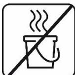
Lassen Sie niemals heißes Wasser in das Gerät fließen, dies kann den Filter und die Ionisierungskammer beschädigen. Wurde versehentlich heißes Wasser durch das Gerät geleitet, müssen der weiße Anschlussschlauch und die Filter getauscht werden. Die optimale Wassertemperatur liegt zwischen 5 und 30° Celsius.
